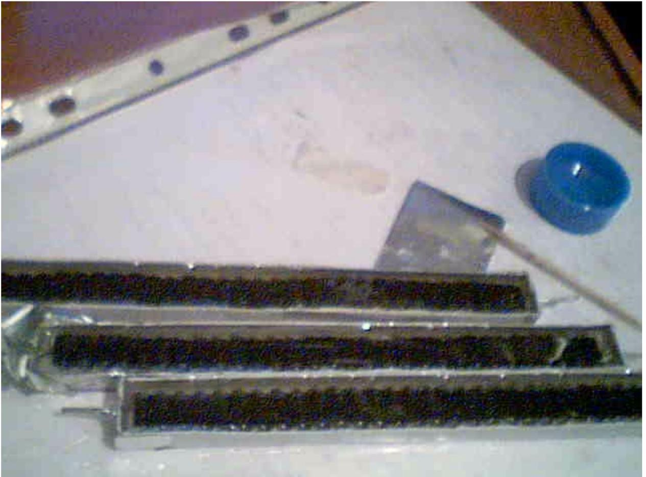
Контурные конденсаторы (для катушек L1 , L2)
